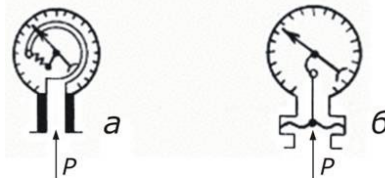
Рис. 2.2. Механические приборы для измерения давления: пружинный трубчатый (а); мембранный (б)
