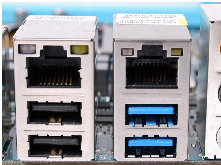
Подключение к ПК к голубому порту USB 3.0
