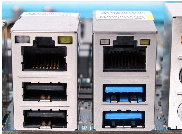
Подключение к ПК к голубому порту USB 3.0
