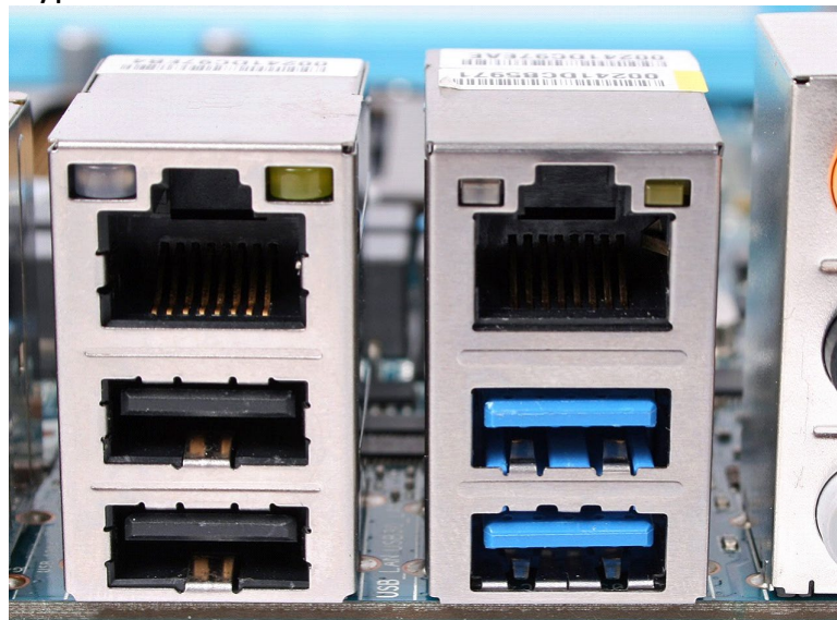
Подключение к ПК к голубому порту USB 3.0
