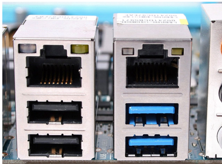
Подключение к ПК к голубому порту USB 3.0
