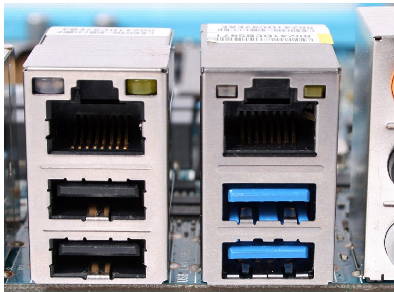
Подключение к ПК к голубому порту USB 3.0
