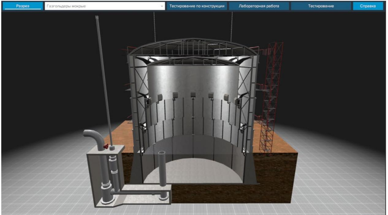
*Модель резервуара с разрезом*
