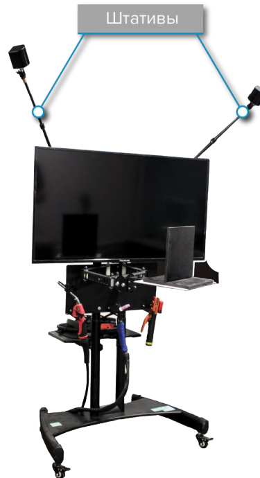
Стенд с закрепленными на штативах базовыми станциями
