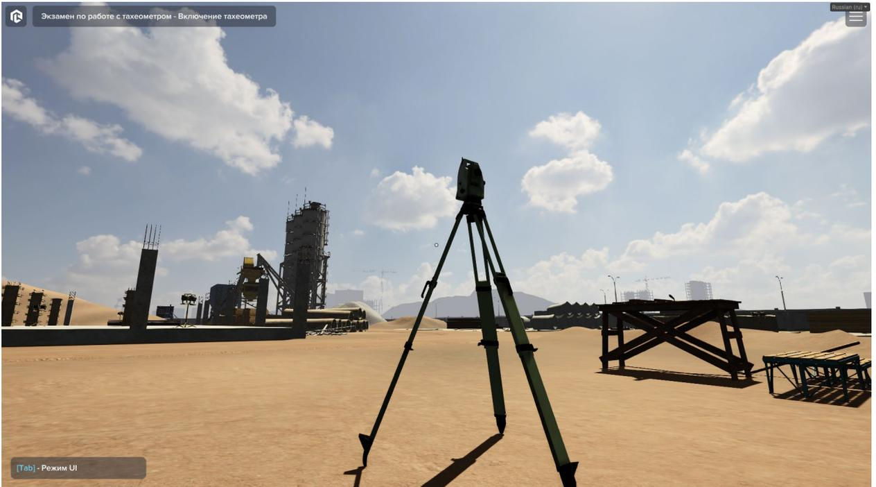
*Тахеометр в рабочем положении*
