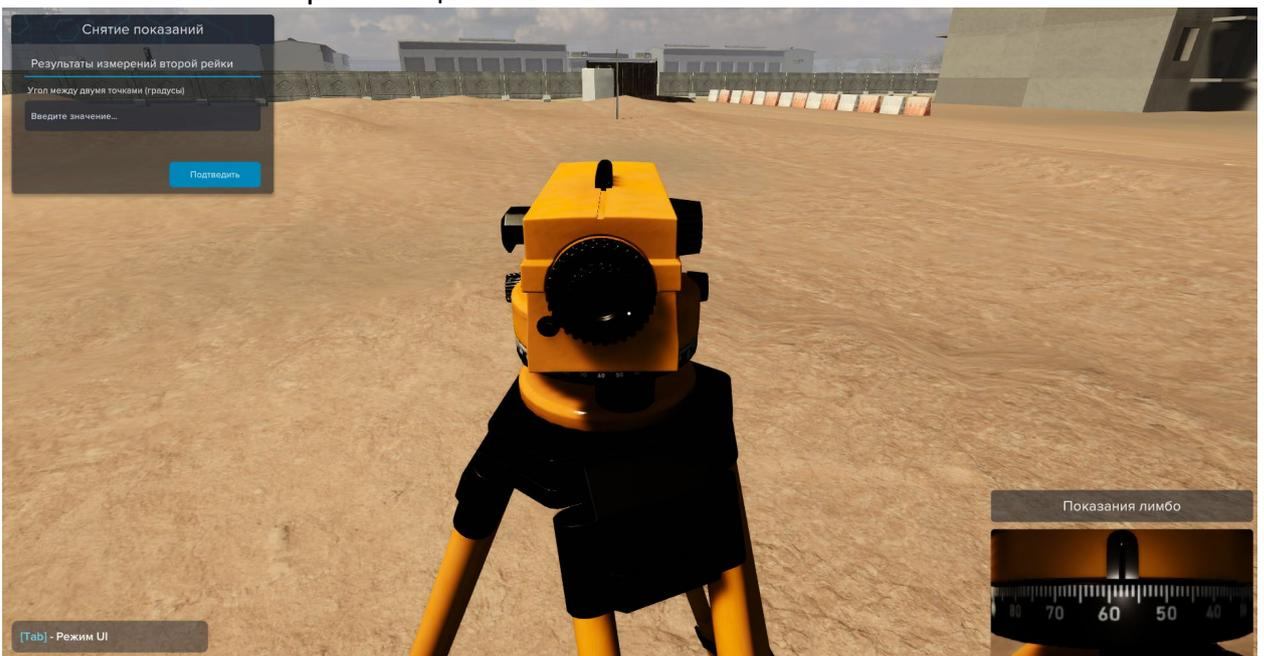
Чтобы посчитать разницу между двумя рейками, следует узнать разность значений центральных дальномерных штрихов с рейки 1 и 2. Модуль этой разницы и будет разницей высот.
