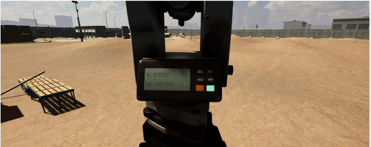
*Включенный прибор. Кнопка запуска подсвечивается зеленым*
