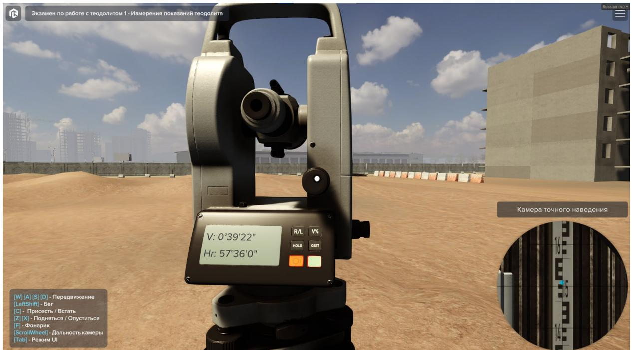
*Измерение вертикального угла*
