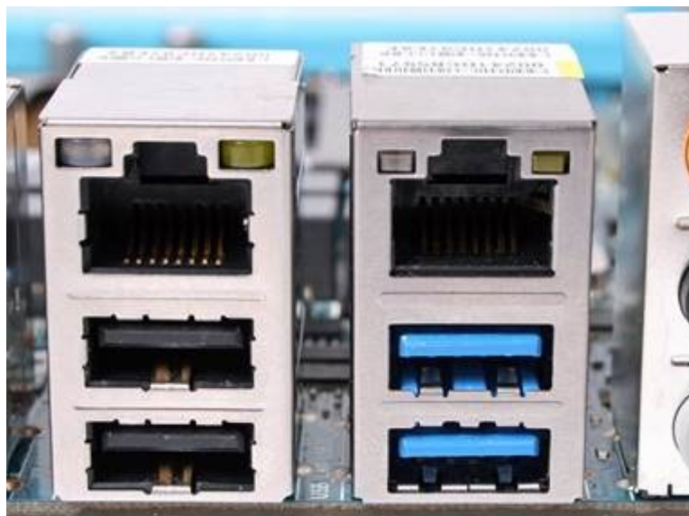
Подключение к ПК к голубому порту USB 3.0
