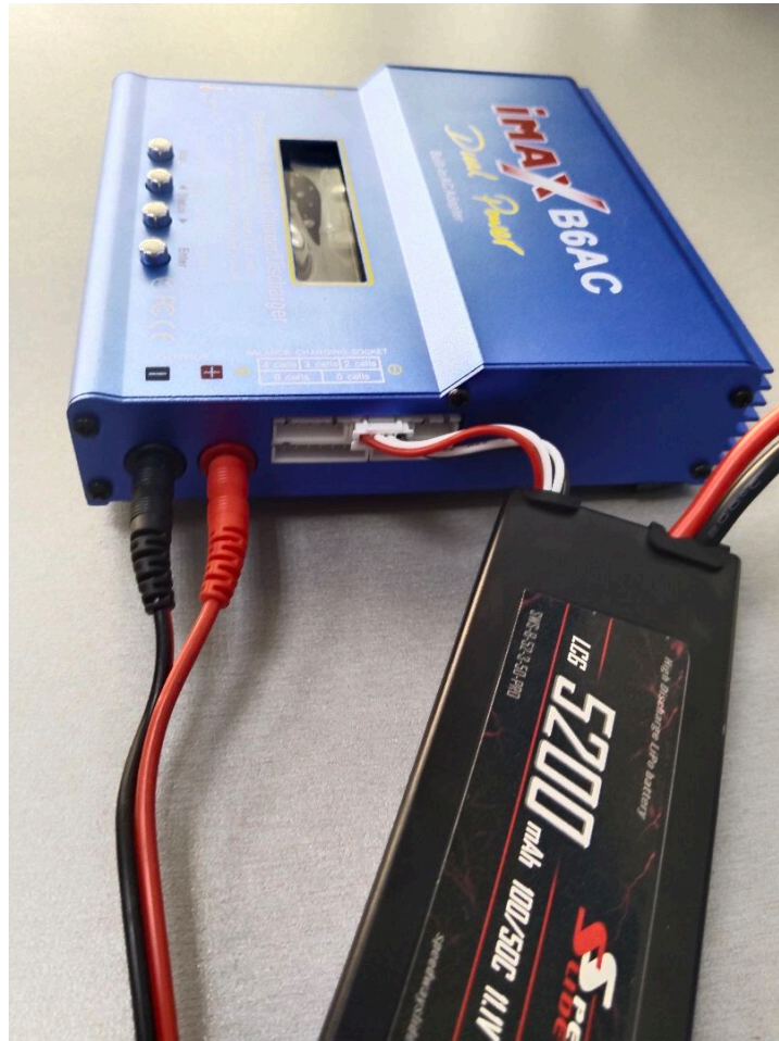
Подключение АКБ к балансировочному разъему
