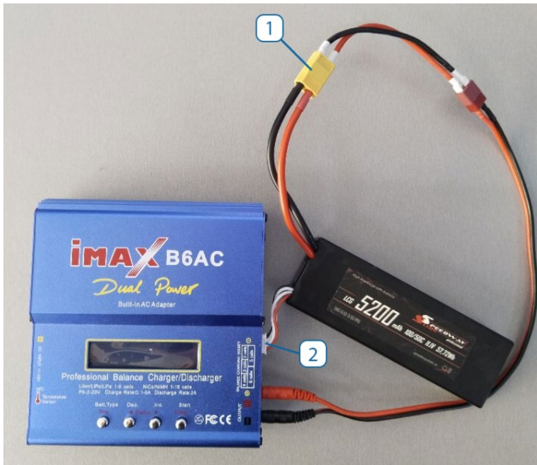
Аккумуляторная батарея подключенная к стандартному и балансировочному разъему
