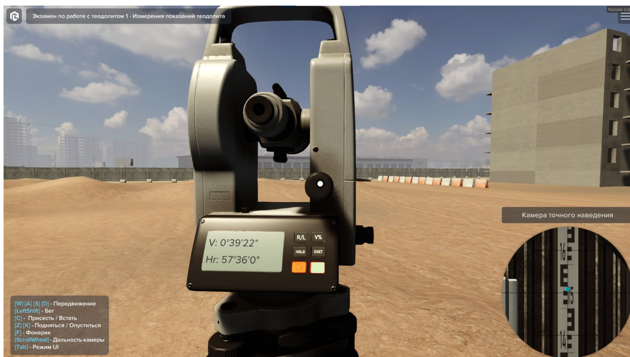
Измерение вертикального угла
