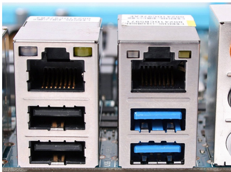
Подключение к ПК к голубому порту USB 3.0
